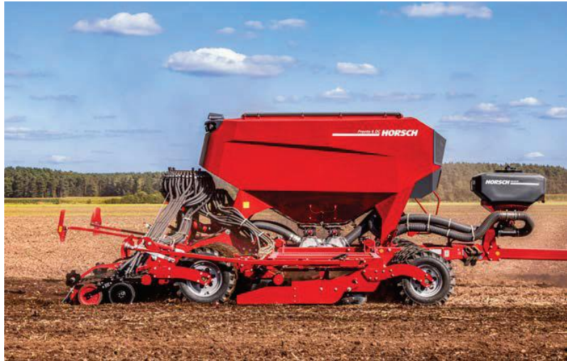
Bessere Feldaufgänge durch Krümeln, Rückverfestigen und Andrücken in einem Arbeitsgang war das Ziel bei der Entwicklung der Pronto.
