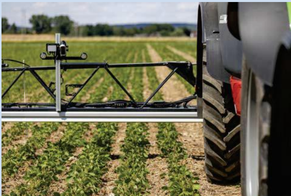
Streifenapplikation mit einer HORSCH Leeb LT: Steuerung der Achsschenkelenkung über ein Kamerasystem.
